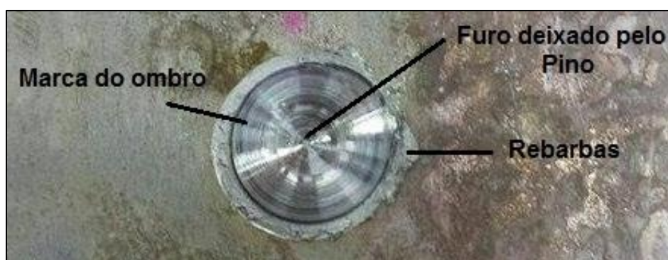
Figura 2: Fatores representativos do processo de soldagem FSSW. Fonte: Autores (2017).
