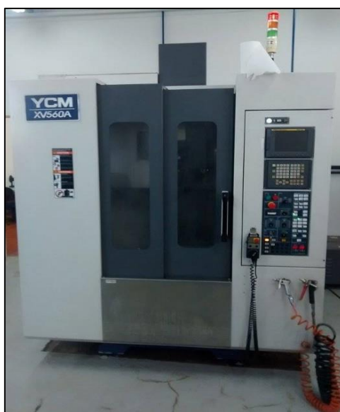
Figura 3: Centro de usinagem CNC utilizado para realizar a solda FSSW.
