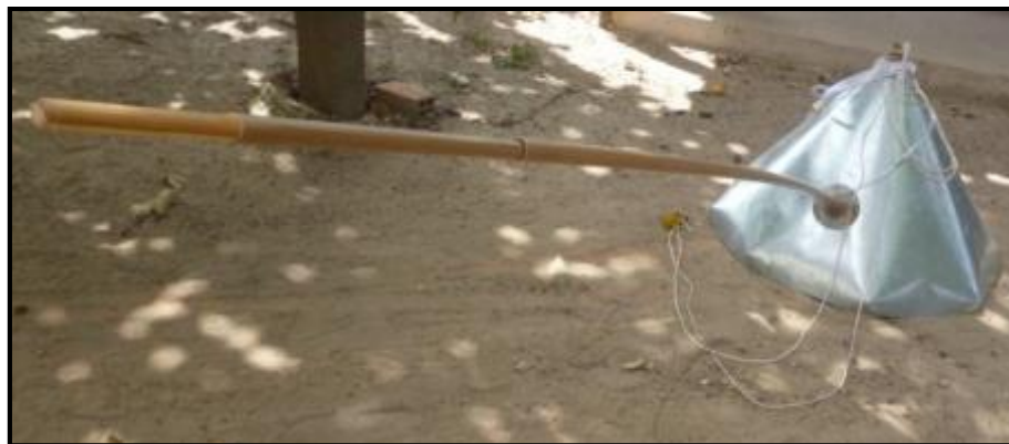
Figura 5: Sistema de captação de gás metano construído.
