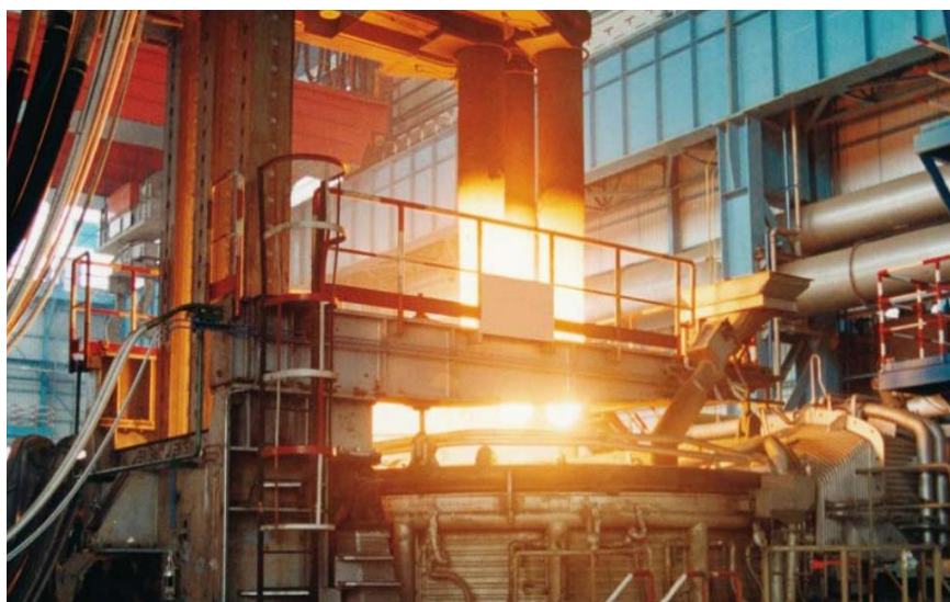
Figura 1: Forno Elétrico à Arco (Cortesia TENOVA)
