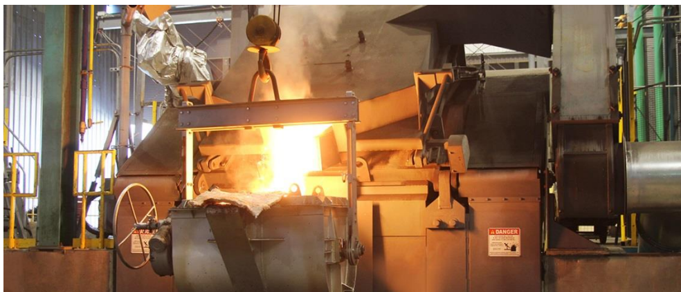
Figura 2: Forno de Indução (Cortesia Inductoterm)
