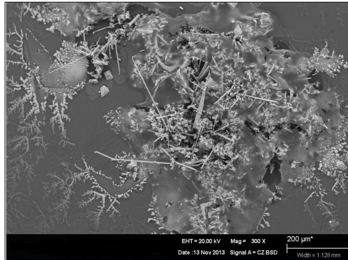
Figura 62: Micrografia eletrônica de varredura (MEV) da região 1 (a) e região 2 (b) da membrana seca naturalmente após sua utilização com um aumento de 300x.
